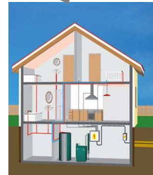
Variante 4 Dachs SE Brennwert, inkl Warmwasserbereitung
